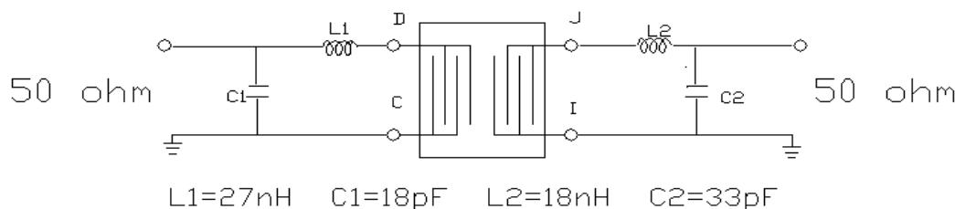
\* Конкретные номиналы LC элементов согласующих цепей зависят от паразитных емкостей и индуктивностей в печатной плате измерительного устройства или аппаратуры Заказчика.
