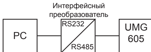
Рис. 13.2. Подключение UMG605 к ПК через интерфейсный преобразователь.
