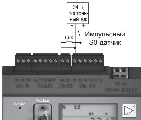
Рис. 41.1. UMG605 со входами на 24 В. Пример с импульсным S0-датчиком.
