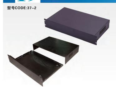
本机箱由铝型材面板、上下盖板、后盖板等组成,机箱深度D可按要求任意定制。铝型材面板可按要求开孔,内部可定制PCB固定螺柱。
