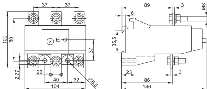
Рис.4 Габаритные и присоединительные размеры PT3-4355...PT3-4315 вариант 1
