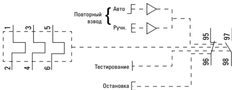
Рис. 2 Схема реле РТЗ-4355...РТЗ-4315
