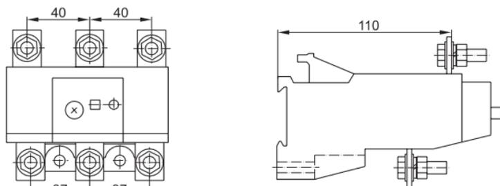
Рис.5 Присоединительные размеры PT3-4355...PT3-4315 вариант 2
