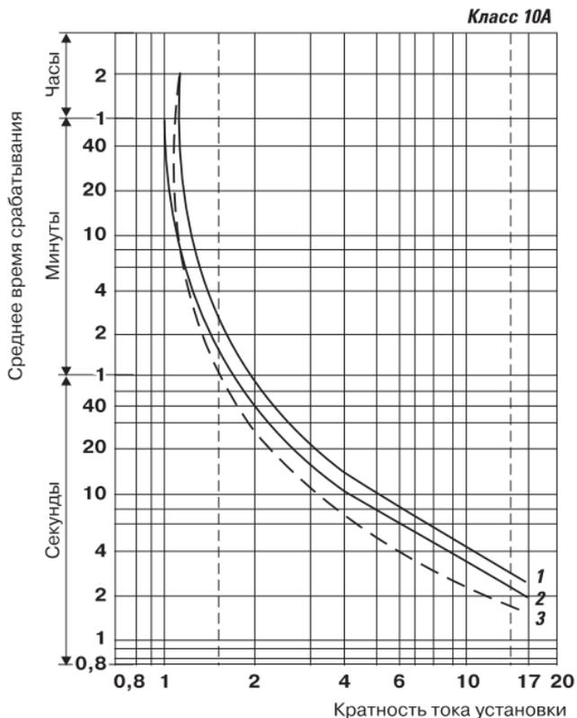
Рис. 1 Время-токовые характеристики отключения
