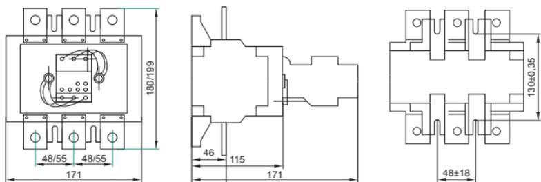
Рис.6 Габаритные размеры PT3-53125
