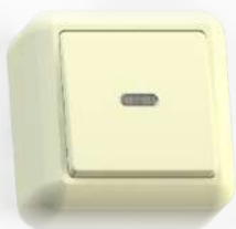
A110-386 «с/к» Выключатель одноклавишный с подсветкой Номинальный ток - 10А 62x62x35,4 мм
