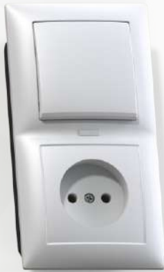
БКВР-417 Блок комбинированный Выключатель одноклавишный с подсветкой + розетка Номинальный ток: - выключателя - 10А - розетки - 16А 80,4x150,4x42,2 мм
