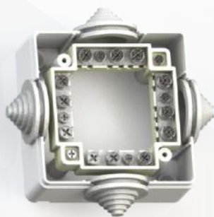
KOA-001 Коробка ответвительная с контактной группой брызгозащищенная Ip44 Номинальное напряжение - не более 440 В Кол-во вводов в корпус - 4 Кол-во контактных групп - 4 Кол-во присоединяемых проводников на контактную группу - 6 78x78x42 мм (вид со снятой крышкой)
