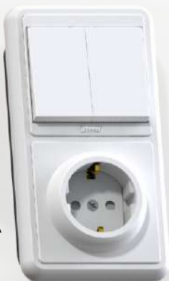
БКВР-210 Блок комбинированный Выключатель двухклавишный с подсветкой + розетка с заземляющим контактом и защитной шторкой Номинальный ток - 10А 82x152x48 мм
