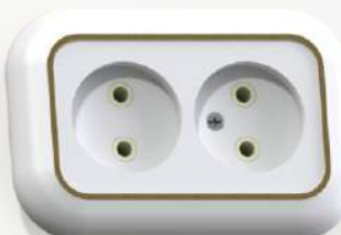
PC10-393 «з» Розетка двухместная Номинальный ток - 10А 81x120x45 мм
