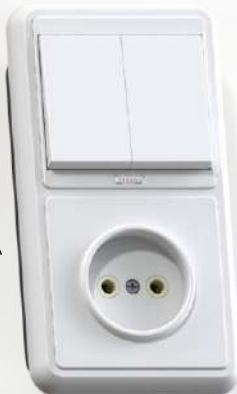
БКВР-213 Блок комбинированный Выключатель двухклавишный с подсветкой + розетка Номинальный ток - 10А 82x152x41 мм
