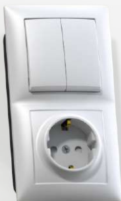
БКВР-415 Блок комбинированный Выключатель двухклавишный + розетка с заземляющим контактом и защитной шторкой Номинальный ток: - выключателя - 10А - розетки - 16А 80,4x150,4x45,7 мм
