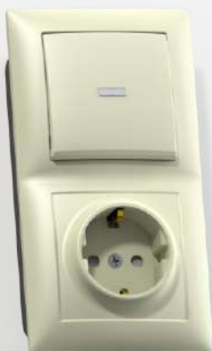
БКВР-423 «с/к» Блок комбинированный Выключатель одноклавишный с подсветкой + розетка с заземляющим контактом и защитной шторкой Номинальный ток: - выключателя - 10А - розетки - 16А 80,4x150,4x45,7 мм
