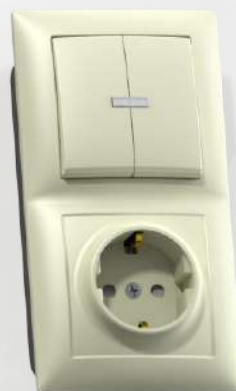
БКВР-424 «с/к» Блок комбинированный Выключатель двухклавишный с подсветкой + розетка с заземляющим контактом и защитной шторкой Номинальный ток: - выключателя - 10А - розетки - 16А 80,4x150,4x45,7 мм
