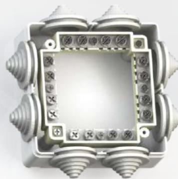
KOA-003 Коробка ответвительная с контактной группой брызгозащищенная Ip44 Номинальное напряжение - не более 440 В Кол-во вводов в корпус - 8 Кол-во контактных групп - 4 Кол-во присоединяемых проводников на контактную группу - 8 90x90x42 мм (вид со снятой крышкой)
