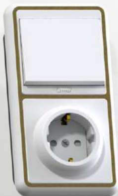
БКВР-211 «з» Блок комбинированный Выключатель одноклавишный с подсветкой + розетка с заземляющим контактом и защитной шторкой Номинальный ток - 10А 82x152x48 мм
