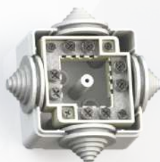
KOA-002 Коробка ответвительная с контактной группой брызгозащищенная Ip44 Номинальное напряжение - не более 440 В Кол-во вводов в корпус - 4 Кол-во контактных групп - 2 Кол-во присоединяемых проводников на контактную группу - 8 60x60x42 мм (вид со снятой крышкой)
