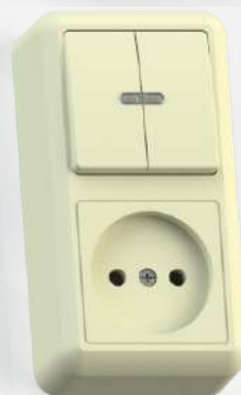
БКВР-431 «с/к» Блок комбинированный Выключатель двухклавишный с подсветкой + розетка Ном. ток выключателя - 10А Ном. ток розетки - 16А 62x116x35,9 мм
