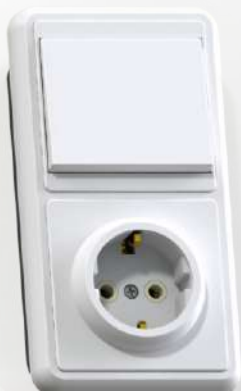
БКВР-034 Блок комбинированный Выключатель одноклавишный + розетка с заземляющим контактом и защитной шторкой Номинальный ток - 10А 82x152x48 мм
