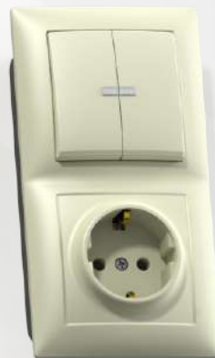
БКВР-421 «с/к» Блок комбинированный Выключатель двухклавишный с подсветкой + розетка с заземляющим контактом Номинальный ток: - выключателя - 10А - розетки - 16А 80,4x150,4x45,4 мм
