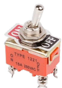
36-4130 Тумблер ON-OFF двухполюсный Модель | KN-201 Номинальное напряжение | 250В Номинальный ток | 15А Тип переключения | ON-OFF Количество контактных групп | 2 Контактных в контактной группе | 2 Установочный размер | Ø12 мм
