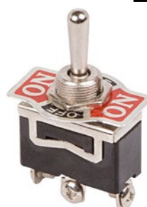
36-4112 Тумблер ON-OFF-ON однополюсный Модель | KN-103 Номинальное напряжение | 250В Номинальный ток | 15А Тип переключения | ON-OFF-ON Количество контактных групп | 1 Контактных в контактной группе | 3 Установочный размер | Ø12 мм
