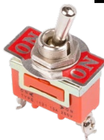
36-4111 Тумблер ON-ON однополюсный Модель | KN-102 Номинальное напряжение | 250В Номинальный ток | 15А Тип переключения | ON-ON Количество контактных групп | 1 Контактных в контактной группе | 3 Установочный размер | Ø12 мм
