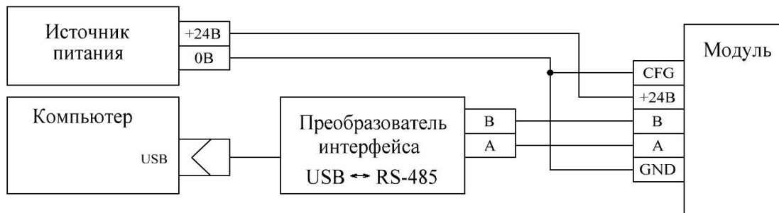
Рисунок 6 – Подключение модуля к компьютеру для конфигурации.
