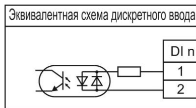
Рисунок 5 – Эквивалентная схема канала ввода дискретных сигналов.
