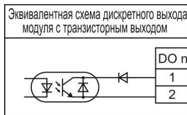
Рисунок 12 – Эквивалентная схема канала вывода дискретных сигналов
